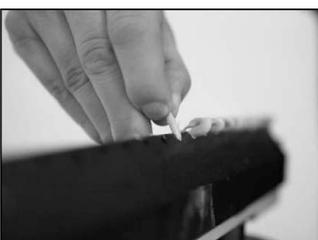
Использовать для очистки растворитель Sika® Remover-208 и удалить остатки клея ветошью. Хорошо подходят также очищающие салфетки Sika® TopClean-T. После тщательной очистки привинтить на место боковые защитные крышки. Теперь можно вытащить затвердевшие «червячки».
