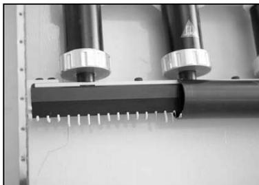
После заполнения устройства SikaBond® Dispenser-5400 тремя трубчатыми пакетами по 1800 мл каждый его следует подключить к компрессору. Устройство SikaBond® Dispenser-5400 равномерно провести над полом, включив подачу сжатого воздуха. Ширина полосы клея составляет около 55 см. Количество выдавливаемого клея регулируется регулировочным клапаном давления
