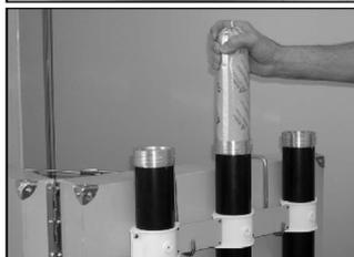
3. Поршень продвинуть назад в трубе новым трубчатым пакетом.
