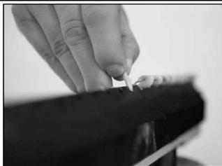
Если потребуется продолжать работу с устройством SikaBond® Dispenser-5400, необходимо вытащить из отверстий распределителя застывшие «червячки» клея. После этого устройство SikaBond® Dispenser-5400 снова готово к применению и оставшийся в трубах клей можно наносить.
