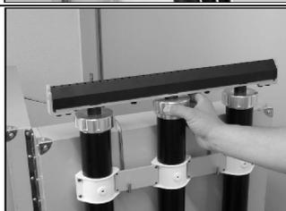
1. Отвинтить три защитных колпачка и снять распределитель клея.
