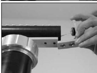
Снять правую и левую защитные крышки.
